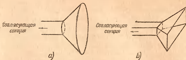
Фиг. 17.1. а) рупор для TE_{1,1} -мода в круглой трубе; б) рупор для TE_{1,1} -мода в прямоугольной трубе.
