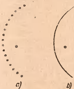
Фиг. 42,7. Разрез по ряду, состоящему из возбуждаемой антенны. а — с пассивными антеннами, размещенными по слегка приплюсненной параболе; б — приплюсненный параболический цилиндр из металлического листа.
