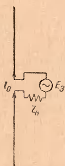
Фиг. 31,1b. Эквивалентная (a) цепь с точки зрения тока в нагрузке.
